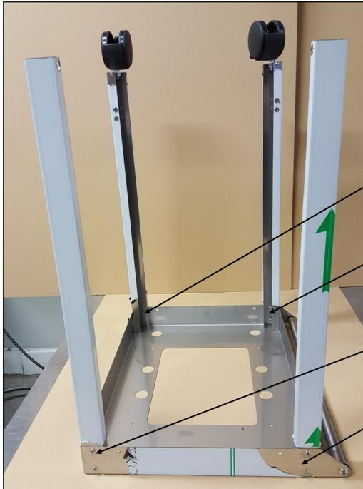
Montage des 2 pieds avec roues pivotantes à l'aide de 8 vis inox M5 x 10
