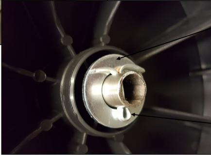
**Montage des 2 rondelles diamètre 12mm**
