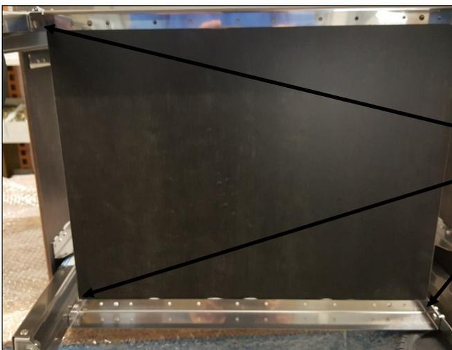
Montage de la tablette centrale à l'aide de 8 vis inox M5 x 10
