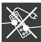
Ne pas brancher la plancha sur une multiprise comportant d'autres appareils électriques. Le câble d'alimentation de la plancha doit être vérifié régulièrement pour détecter des signes de détérioration. Si le câble est endommagé, l'appareil ne doit pas être utilisé. Faire remplacer le câble par le constructeur ou par un technicien agréé ceci afin d'éviter tout danger.
