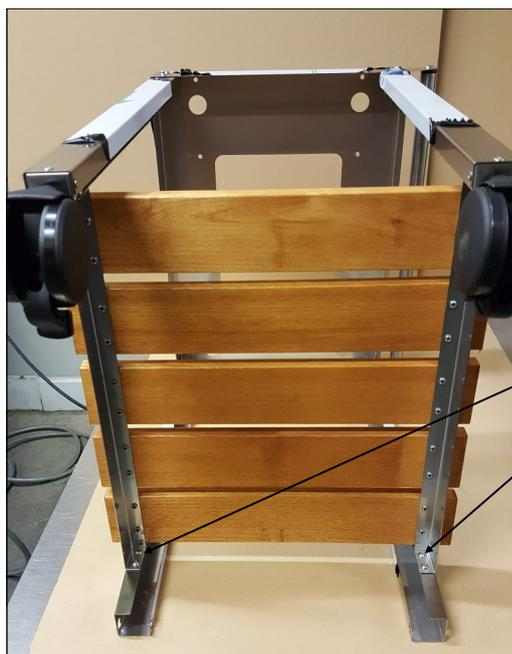
**Montage de la tablette centrale à l'aide de 8 vis inox M5 x 10**
