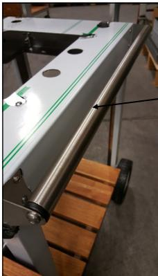
**Montage de la barre à torchon à l'aide de 2 vis inox M8 x 20**
