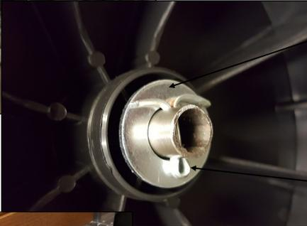
**Montage des 2 rondelles diamètre 12mm**
